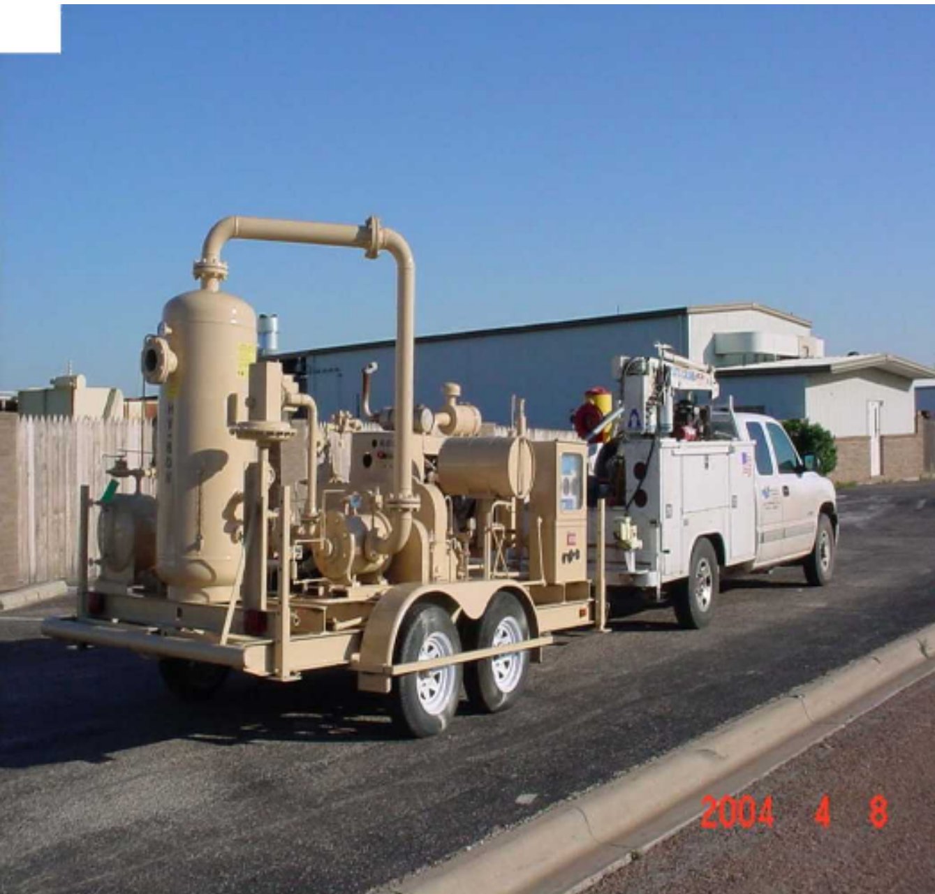
2. Мобильная установка с двигателем на природном газе транспортируется на место испытаний, которые будут продолжаться 45 дней.
